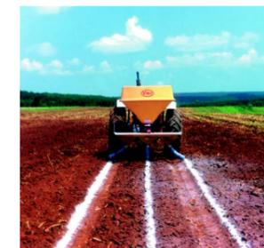
Adubação em três faixas com largura variável em cana-de-açúcar e batata.
