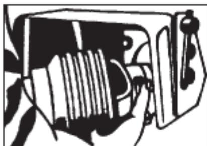
**9-Acople a flange no eixo na TDP do trator observando que o engate só se completará quando a trava saltar.**
